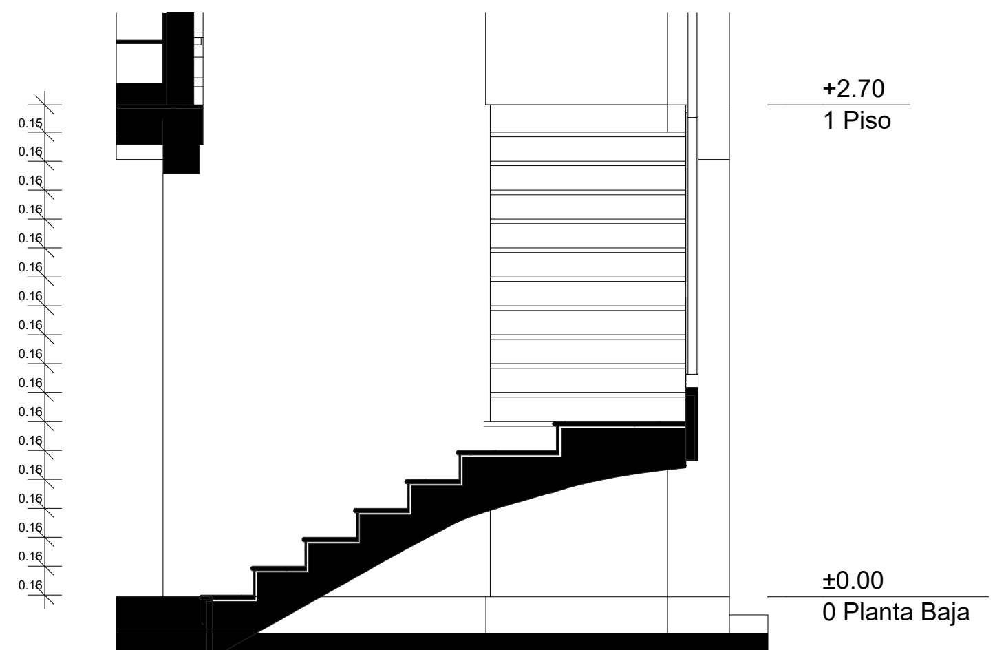
S-04 Sección Construcción 1:20
